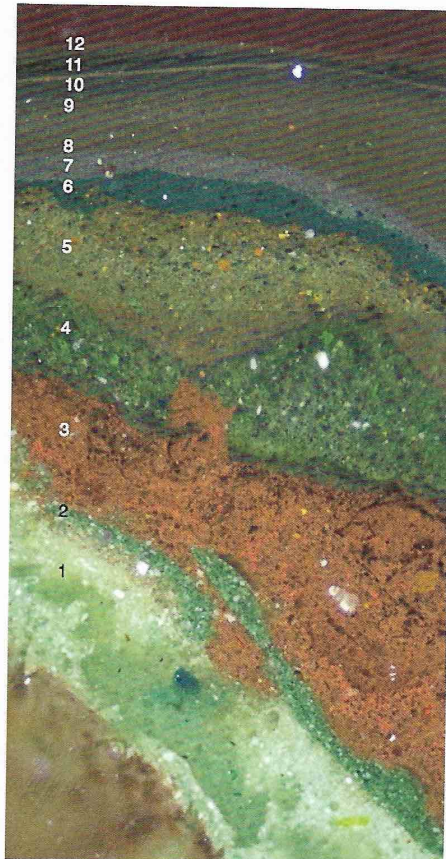
13. Farvesnit udtaget fra pudsprøven (fig. 12). Her ses i alt seks tydelige farvelag, der alle er lyse varme grålige farver.
