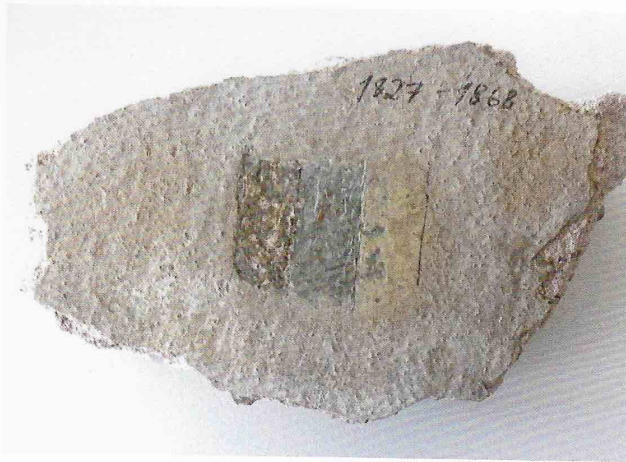
12. Pudsprøve udtaget fra det stykke murstykke, der var skjult under taget fra tilbygningen. Det har ikke været muligt at af-dække mere end fire farvelag. Det ældste farvelag ses til venstre, jf. fig. 13, lag 3. Foto Anne Jonstrup Simonsen.
